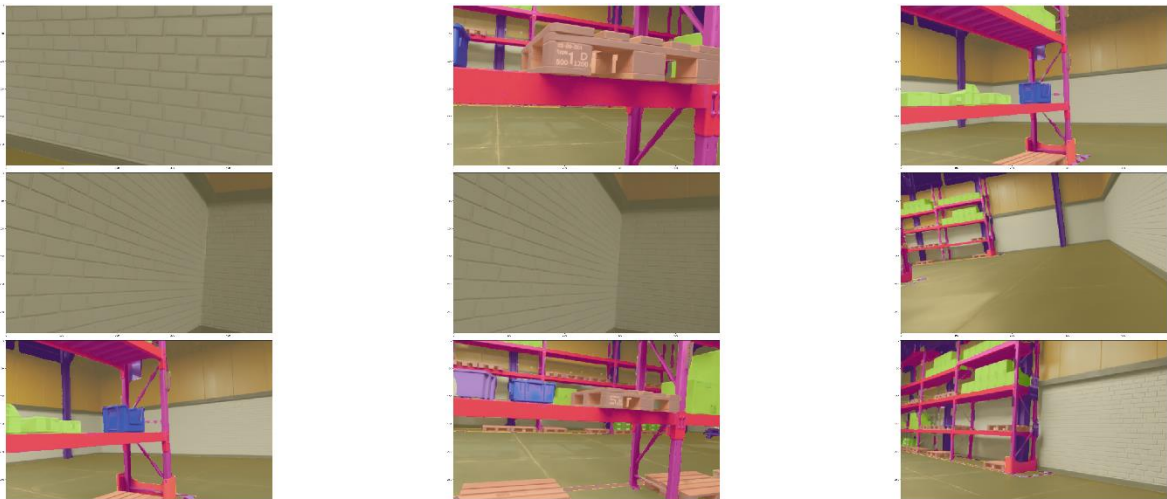
Obrázok 3: Ukážka vytvorených obrázkov z Isaac Sim Replicator. Segmentačná maska s priradenými RGB hodnotami pre každú triedu objektu je preložená cez farebný obrázok.
