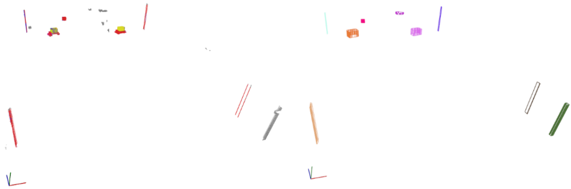
Obrázok 13: Nájdené statické prekážky. Naľavo je mračno bodov bez už nájdených objektov podlahy, stien, regálov. Napravo sú zobrazené polygóny s výškou reprezentujúce prekážky.
