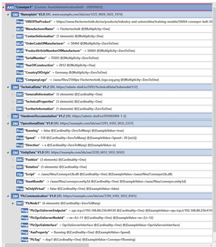
Obrázok 4: Digitálny opis dopravníka v nástroji AASX Package Explorer
