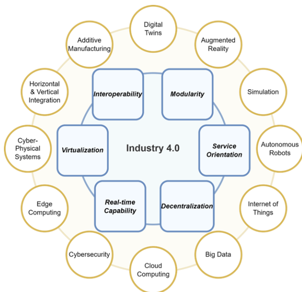
Obrázok 1: Šesť atribútov I4.0 (v strede) spolu s technológiami využívanými k ich implementácii (vonkajšia časť)
